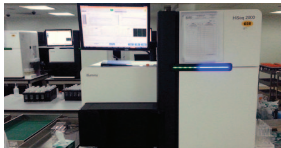
Sekvencerima cijelih genoma moguće je analizirati genome od bakterija do velikih i složenih organizama. Uređaji za sekvenciranje DNK visoke propusnosti poput onih u BGI-ju u Hong Kongu mogu zamijeniti 50 uređaja prethodne generacije te sobe pune opreme za umnožavanje E. coli (kloniranje i pikiranje kolonija putem robota).
